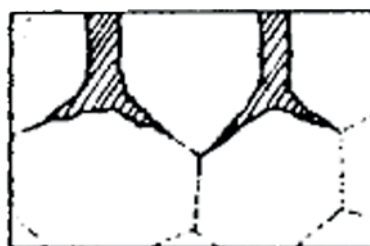
Esquema de la corrosión intergranular
