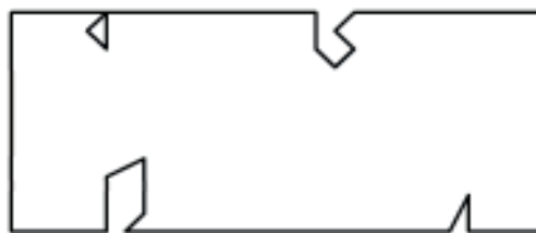
Esquema de la corrosión por picadura
